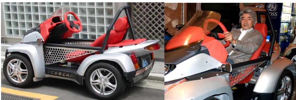
「電気自動車」より一歩進んだ「インホイールモーター」の電気自動車を「電子自動車」。一人乗り、3立方メートルサイズを「SCOOCAR」(スクーカー)と呼びます。日本の車両法では「原付ミニカー」ナンバーで車庫証明、車検、ヘルメット不要。道交法では「普通運転免許」で乗れ、最高速度55km/h(当社)までOKです。家庭用100Vプラグインの8時間充電で約30km走行(1km=約2円)できます。スクーカーは、30km圏内に割り切ったクルマとスクーターの中間車としての機能を徹底追及した、「走る&見られる喜び」が味わえる「排出取引EV」です。
